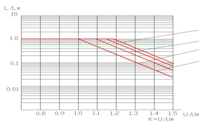
电压温度寿命曲线图
