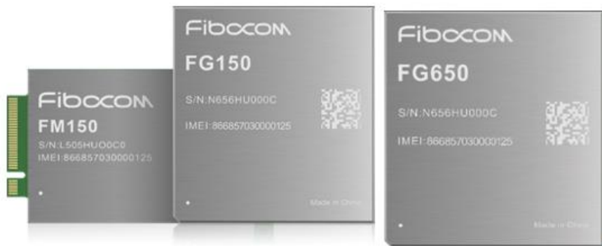
图表 60 FM150、FG150（高通）及 FG650（展锐平台）模组
